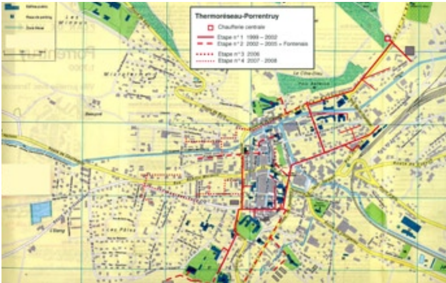
Das Wärmenetz ist etappenweise erweitert worden.
